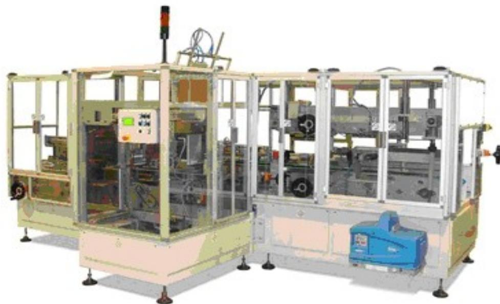
**Encaisseuse horizontale SERVO équipée de:**
