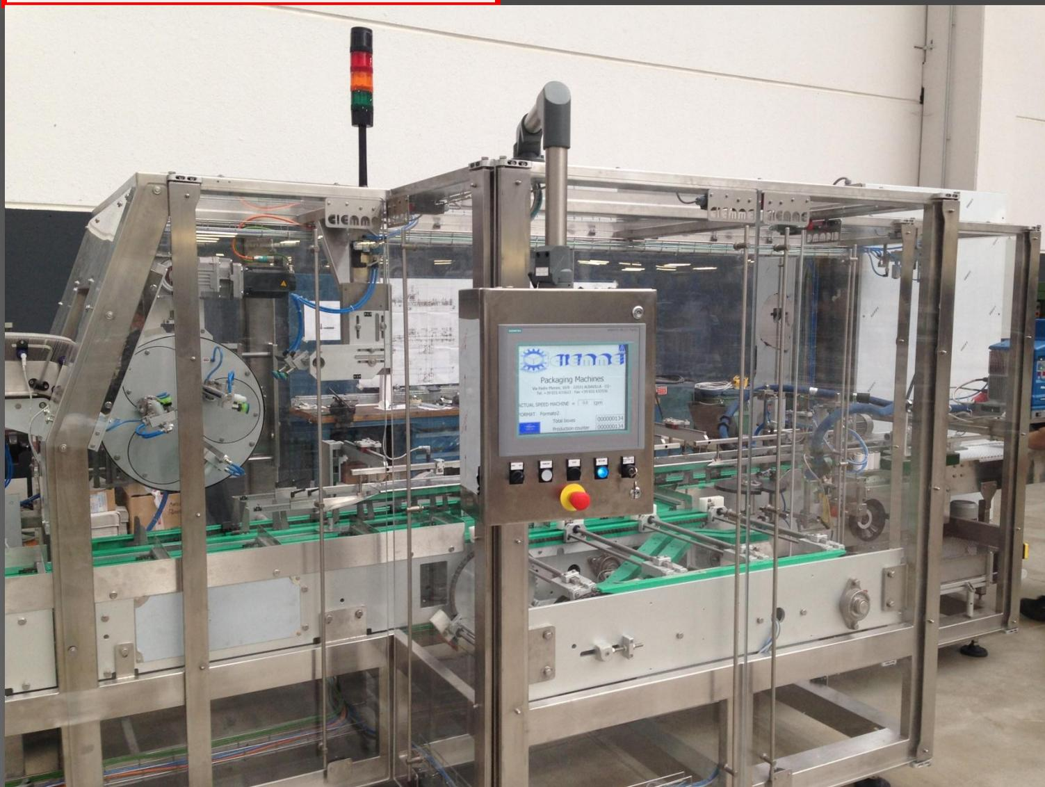
Étuyeuse horizontale AC-100 /200 servo-motorisée avec convoyeur d'entrée à alvéoles et groupe d'introduction automatique des produits dans les étuis.
