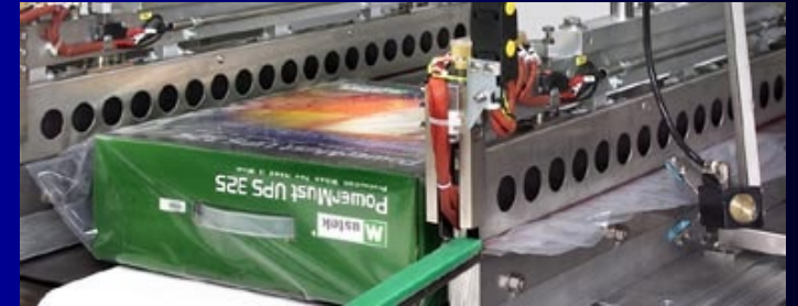
Groupe soudeurs latéraux pour fermeture totale du paquet avant retraction
